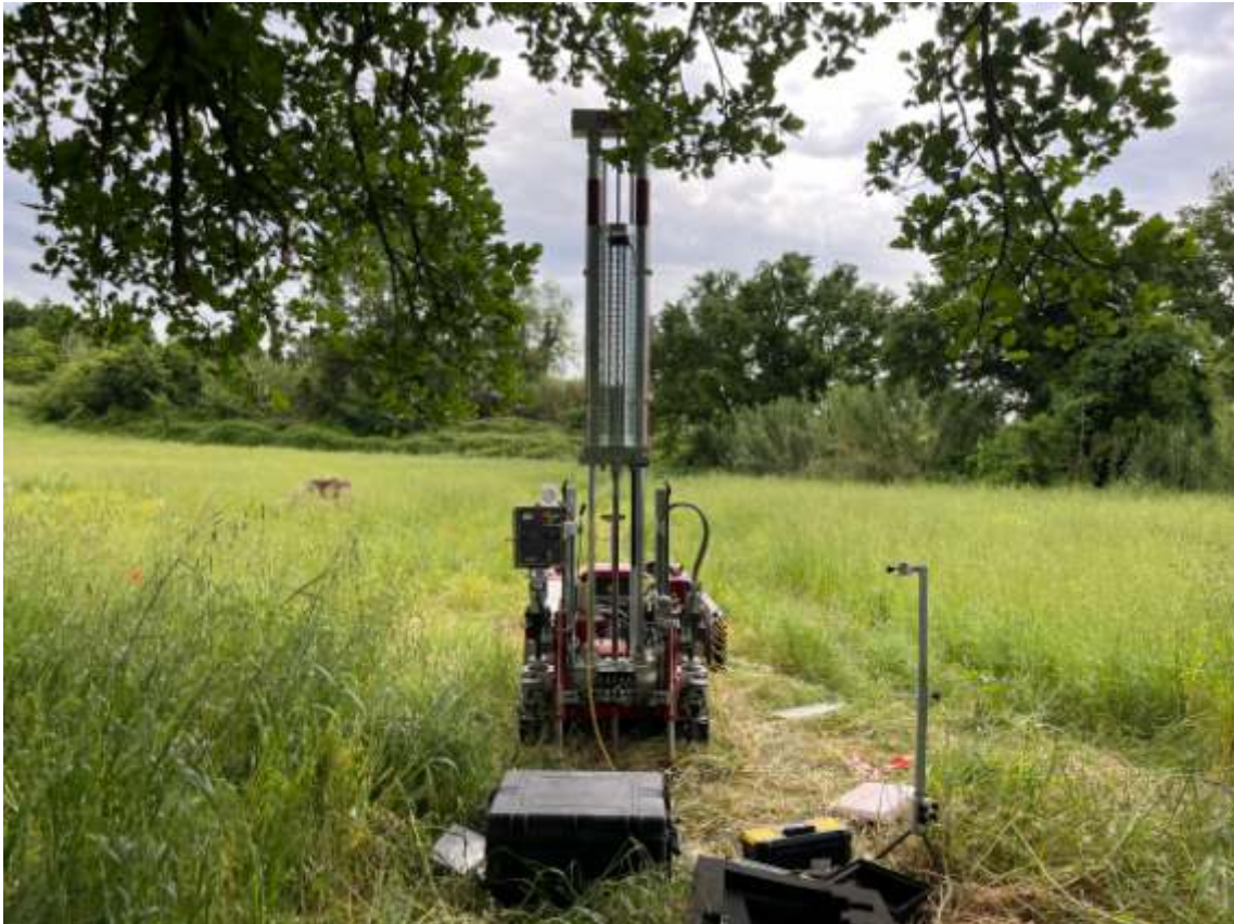
FOTO 1 : Strumentazione utilizzata per l'esecuzione della prova CPTu 2.
