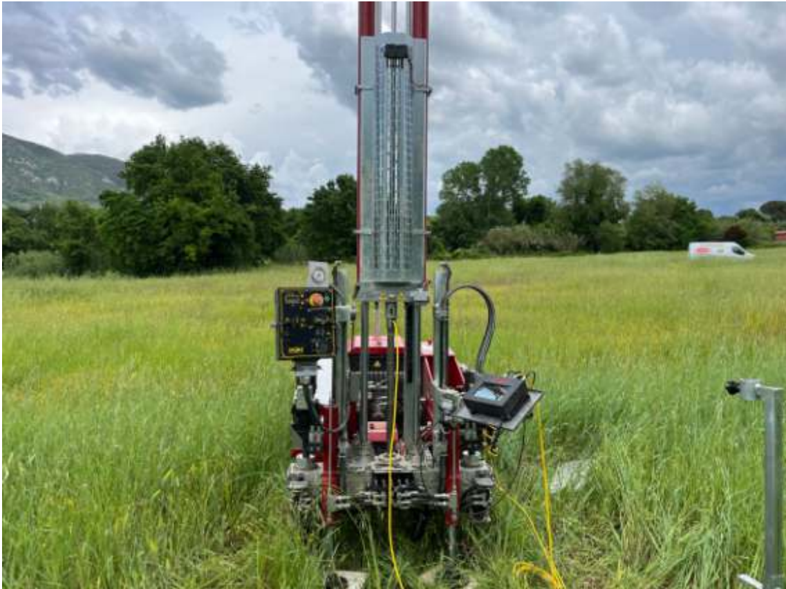
FOTO 1 : Strumentazione utilizzata per l'esecuzione della prova CPTu 4.
