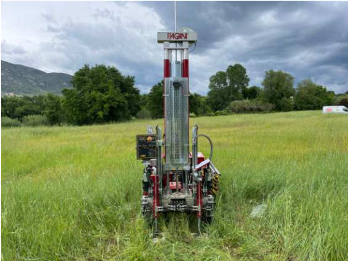
FOTO 1 : Strumentazione utilizzata per l'esecuzione della prova DPSH 4.
