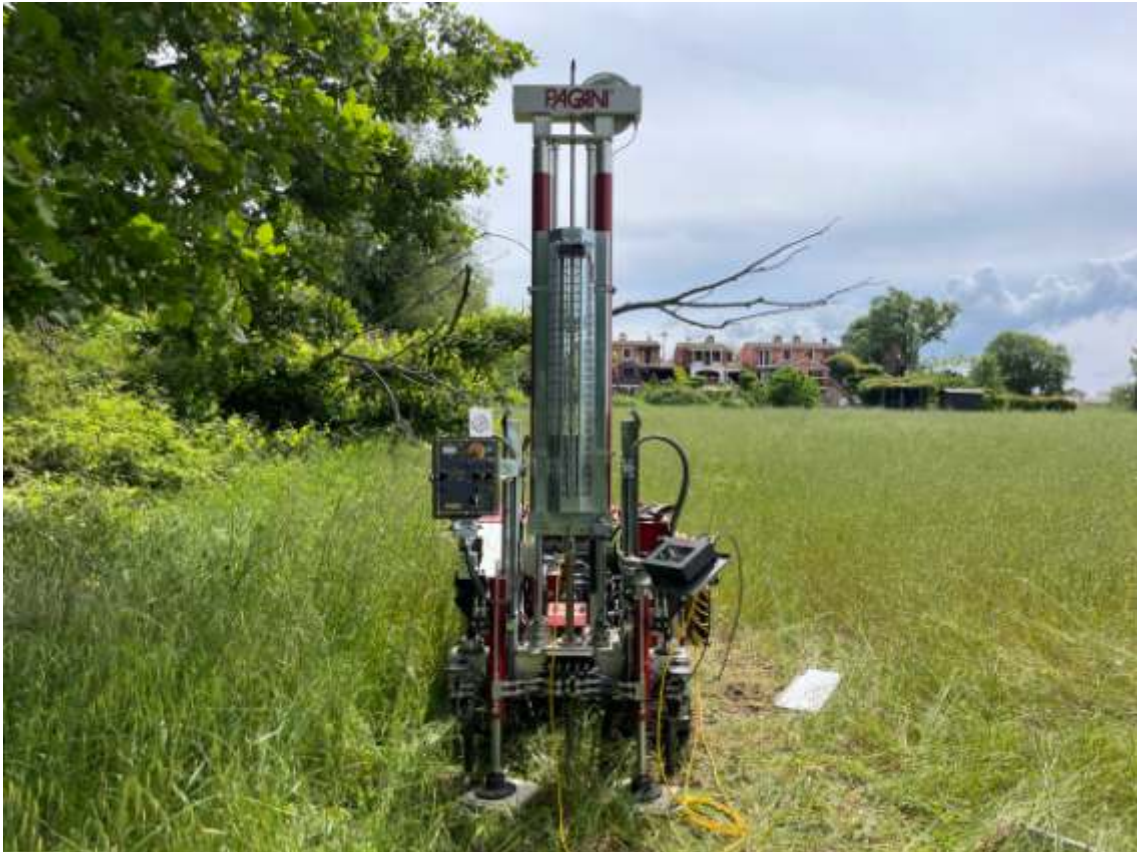
FOTO 1 : Strumentazione utilizzata per l'esecuzione della prova CPTu 7.
