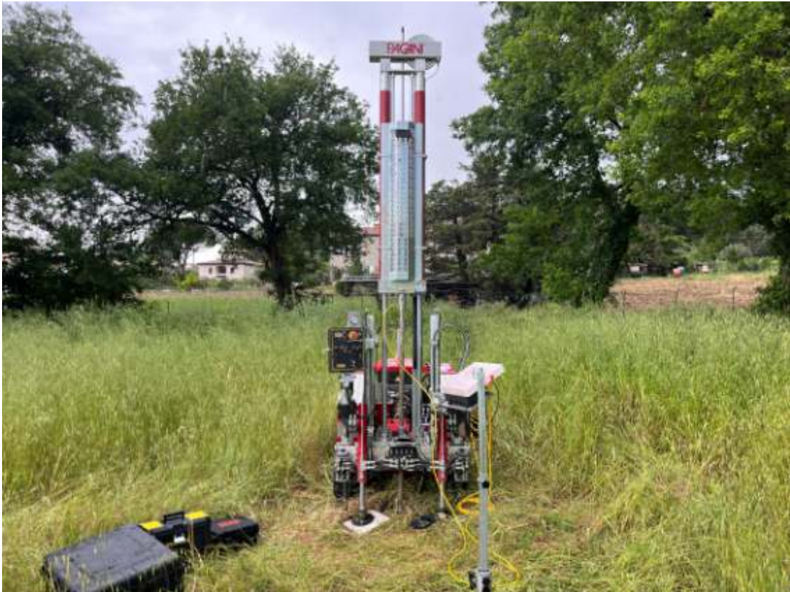
FOTO 1 : Strumentazione utilizzata per l'esecuzione della prova CPTu 1.
