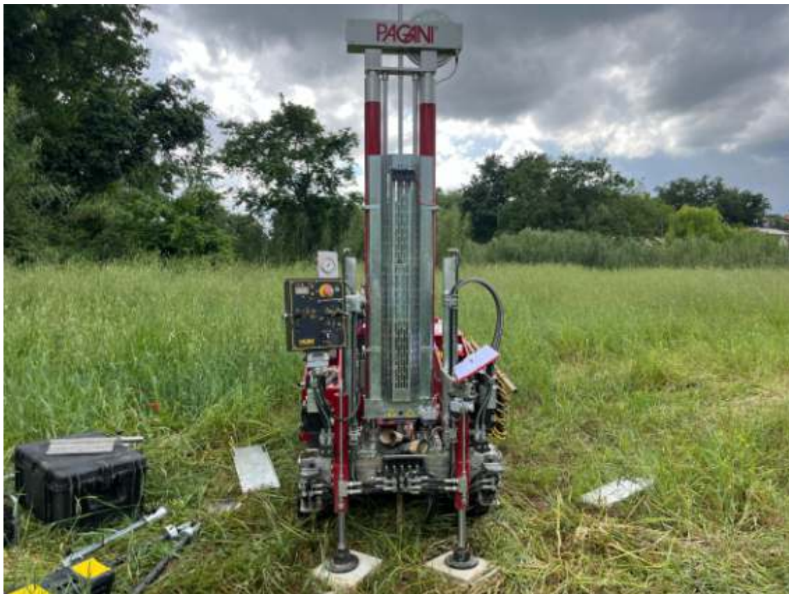
FOTO 1 : Strumentazione utilizzata per l'esecuzione della prova DPSH 6.
