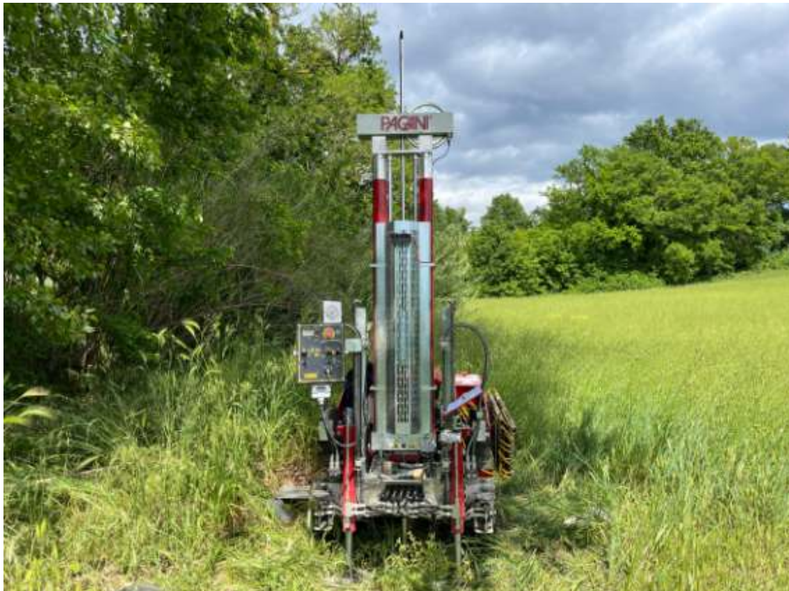
FOTO 1 : Strumentazione utilizzata per l'esecuzione della prova DPSH 5.
