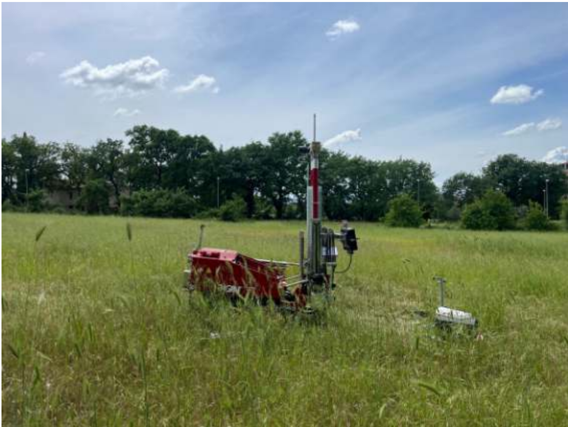
FOTO 1 : Strumentazione utilizzata per l'esecuzione della prova CPTu 3.
